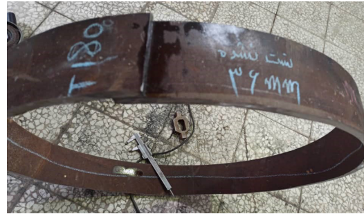
شکل ۱: کاهش قطر ۳۶ میلی‌متر رینگ پیش از آزمون مقاومت شکل ۲: کاهش قطر ۲۸ میلی‌متر رینگ بعد از آزمون هیدرواستاتیک
