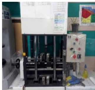
شکل ۹: آزمون خمش و ترک سراسری جوش در نمونه خمش لوله تحت فشار قرار گرفته
