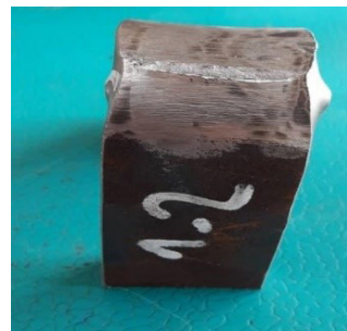
شکل ۹: آزمون خمش و ترک سراسری جوش در نمونه خمش لوله تحت فشار قرار گرفته
