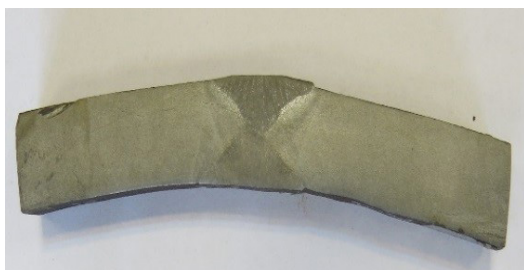
شکل ۱۶: ماکروگرافی جوش پیش از آزمون مقاومت
