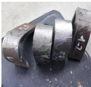
شکل ۹: آزمون خمش و ترک سراسری جوش در نمونه خمش لوله تحت فشار قرار گرفته
