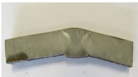
شکل ۱۷: ماکروگرافی جوش پس از آزمون مقاومت
