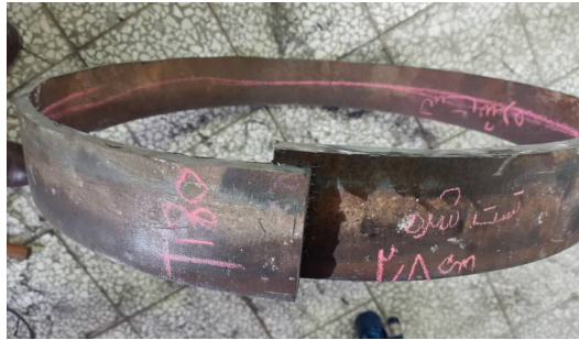
شکل ۱: کاهش قطر ۳۶ میلی‌متر رینگ پیش از آزمون مقاومت شکل ۲: کاهش قطر ۲۸ میلی‌متر رینگ بعد از آزمون هیدرواستاتیک
